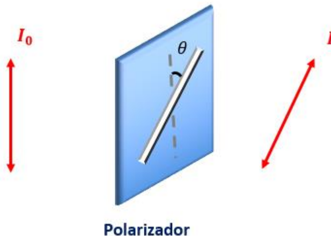
Figura 4: Funcionamento do polarizador.
