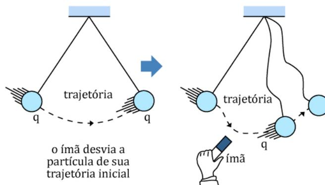
Figura 47: Carga elétrica realizando um movimento pendular. Quando aproximamos um ímã, há um desvio na trajetória.
