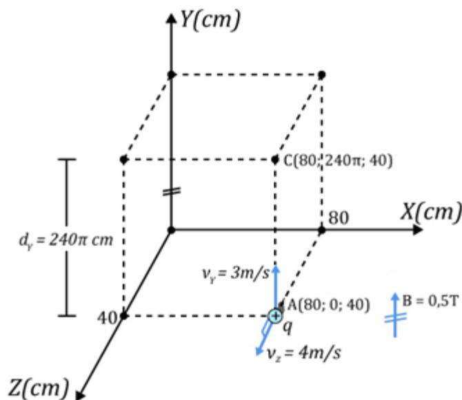
Note que como  $\vec{v}_Y // \vec{B}$ , a partícula descreverá um MRU na direção  $Y$ . Por outro lado,  $\vec{v}_Z$  é perpendicular a  $\vec{B}$ . Logo, a partícula descreverá um MCU no plano  $XZ$ , devido à ação da força magnética.
