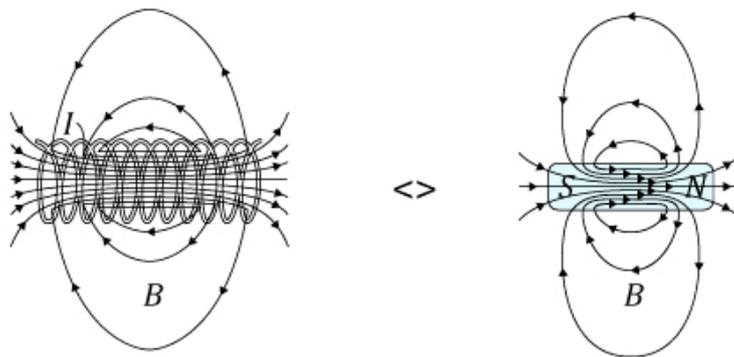
Figura 17: Se aproximarmos limalhas de ferro em um solenoide, elas terão forma semelhante ao aproximá-las de um ímã de barra, pois os campos magnéticos são semelhantes.
