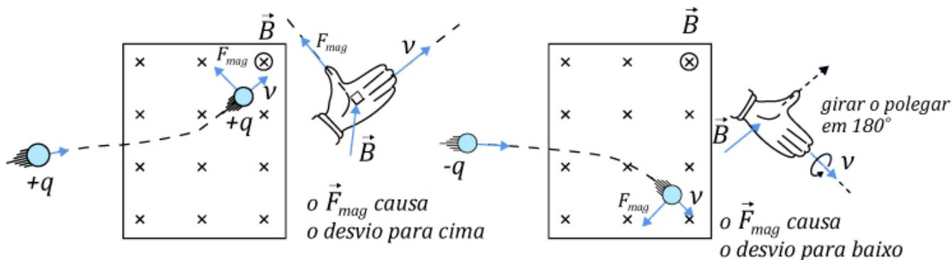
Figura 52: Inversão de sentido de deslocamento, quando a carga tem sinal negativo, em um campo entrando no plano da folha.
