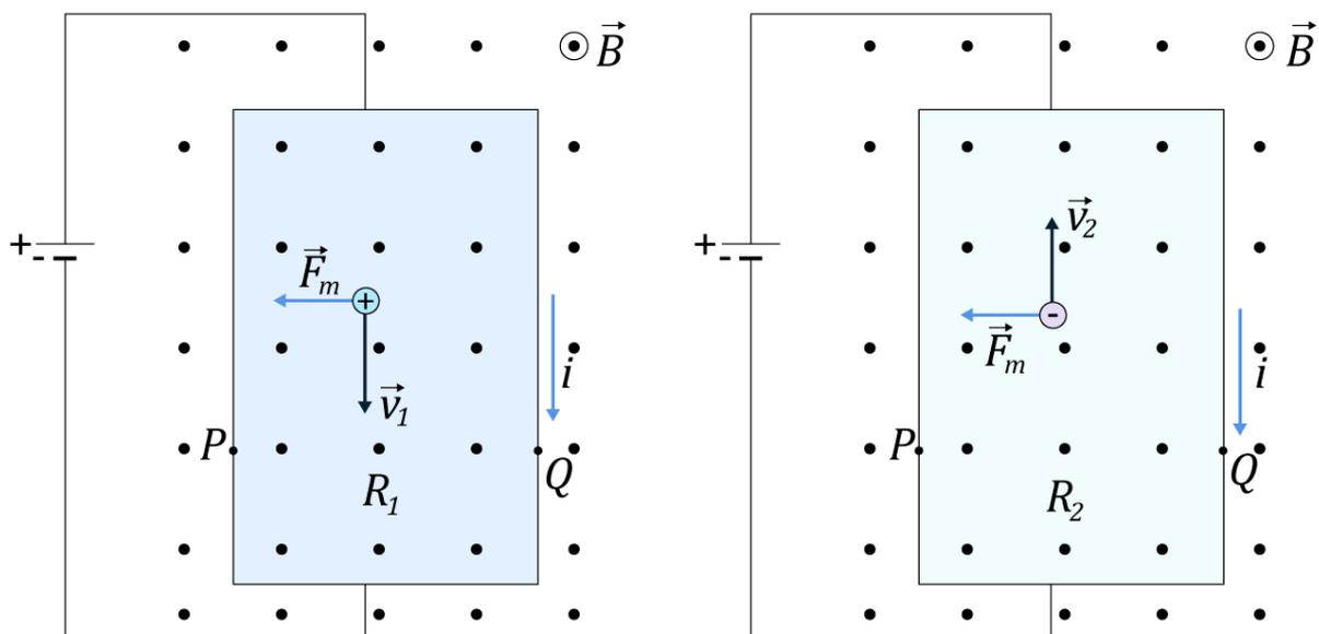
Figura 61: Representação esquemática do experimento de Edwin Hall.
