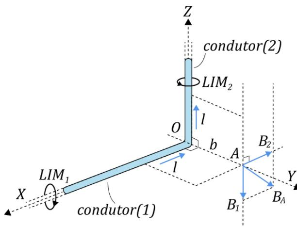
Os sentidos de  $B_1$  e  $B_2$  devido aos fios semi-infinitos  $OX$  e  $OZ$ , respectivamente, geram campos em  $A$  com orientações dadas pela RMD, como na figura logo acima. Note que  $\vec{B}_1$  e  $\vec{B}_2$  estão em um plano paralelo ao formado por  $OX$  e  $OZ$ . Os módulos destes campos são dados por:
