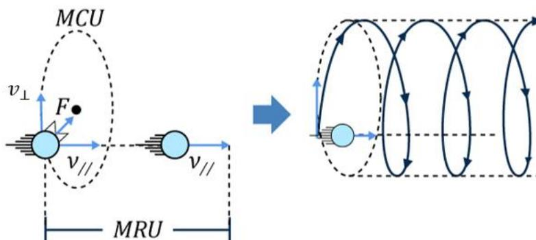
Figura 55: Decomposição da velocidade paralelamente e perpendicularmente ao campo.
