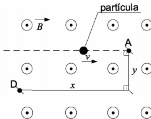
Uma partícula de massa  $m$  e carga elétrica  $+q$  percorre a trajetória tracejada na figura em velocidade constante  $v$ . No instante em que a partícula alcança o ponto A, surge um campo magnético uniforme com intensidade constante  $B$ , emergindo do plano do papel. A intensidade do campo magnético  $B$  para que a partícula alcance o ponto D na continuação de sua trajetória é:
