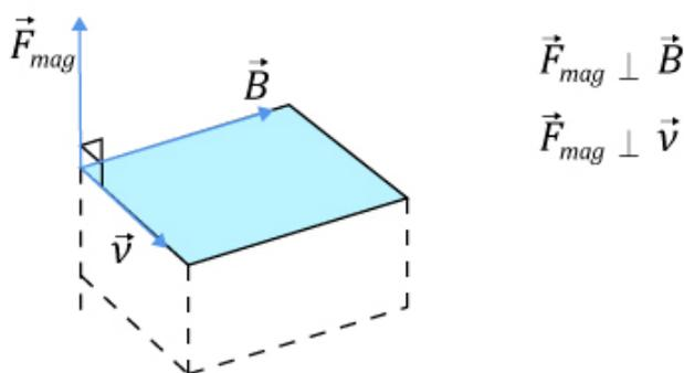
Figura 51: Os três vetores são perpendiculares, induzindo a utilização de produto vetorial para a definição de força magnética.
