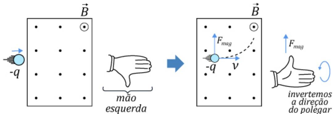
Figura 53: Inversão do sentido do deslocamento, quando a carga tem sinal negativo, em um campo saindo do plano da folha.
