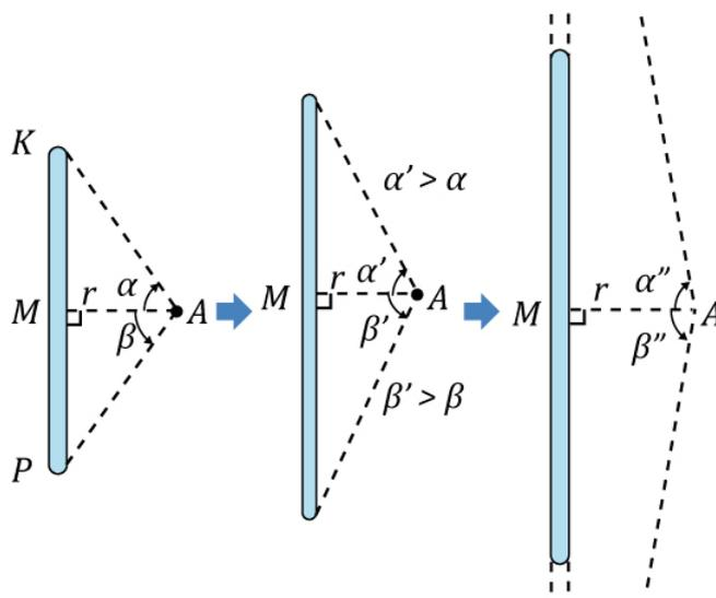
Figura 27: Condutor finito sendo extrapolado para um fio infinito.
