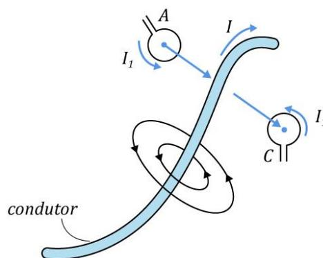
Figura 23: Condutor percorrido por uma corrente elétrica.
