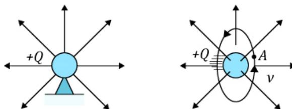
Figura 18: Quando a carga elétrica está em repouso, temos apenas um campo elétrico associado a ela. Entretanto, quando a carga está em movimento, se associa um campo elétrico e um campo magnético.
