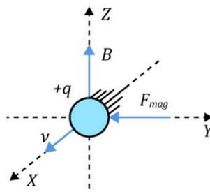
Figura 60: Representação dos vetores em uma carga no espaço.
