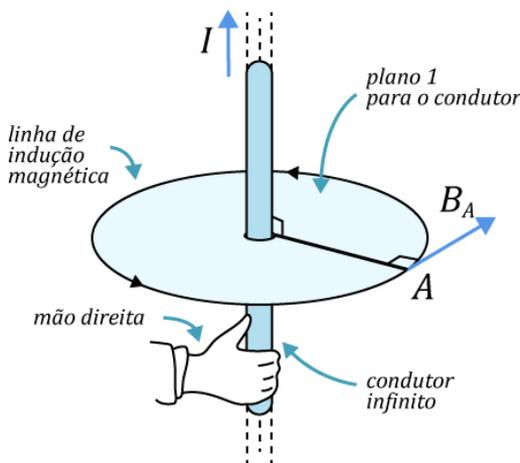
Figura 28: Indução magnética de um fio condutor infinito.
