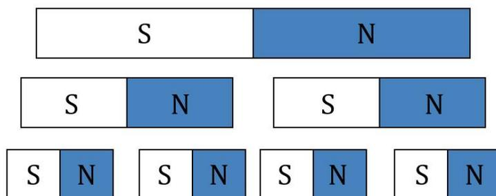
Figura 5: Princípio da inexistência do monopolo magnético.
