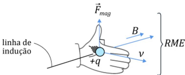
Figura 50: Aplicação da regra da mão esquerda espalmada para a determinação da orientação da força magnética.
