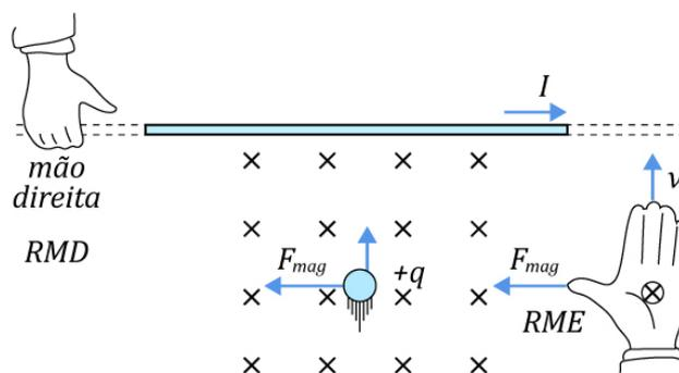
Para a configuração mostrada no enunciado do problema, a força magnética é horizontal e orientada para a esquerda. Analisando a dinâmica do problema, vemos que a força magnética é sempre perpendicular à velocidade e este fato traz consequências importantes.
