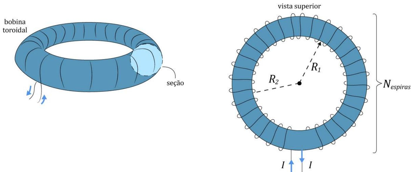
Figura 45: Representação de uma bobina toroidal.
