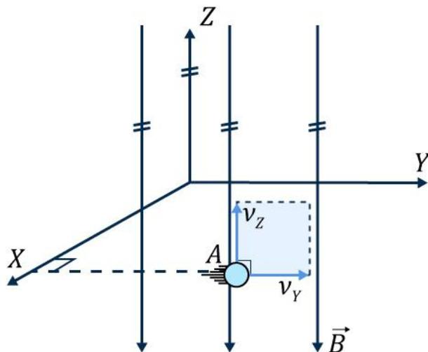
Como a partícula está eletrizada com uma carga positiva, então magnética que surge na carga é perpendicular à velocidade  $v_Y$  e às linhas de indução magnética. Dessa forma, a força magnética é dada pela RME, utilizando a velocidade  $v_Y$  e o campo  $B_Z$ . A componente da velocidade  $v_Z$  apenas desloca a partícula na direção de  $Z$ . A direção da força magnética é dada pela RME:
