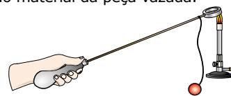
Figura 7. Montagem para comprovar a dilatação térmica de um anel metálico.
