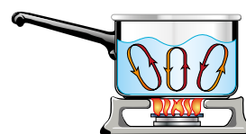
Figura 5. Correntes convectivas no aquecimento de uma massa de água.
