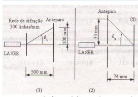
1- O arranjo da figura (1), usando uma rede de difração de 300 linhas por mm, um LASER e um anteparo. Neste arranjo, mediu-se a distância do máximo de ordem 0 ao máximo de ordem 1 da figura de interferência formada no anteparo.
