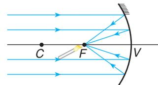
P.260 O espelho a ser utilizado é o côncavo. O filamento da lâmpada deve estar no foco principal  $F$ :
