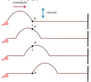
As ondas em uma corda e as ondas eletromagnéticas são exemplos de ondas transversais.
