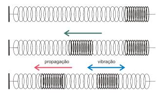
O som, propagando-se no ar ou em líquidos, é um exemplo de onda mecânica longitudinal.
