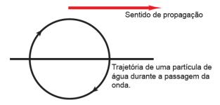
Se um corpo está flutuando na superfície da água em alto-mar, com a passagem da onda, ele irá executar um movimento misto. Veja, na sequência a seguir, como esse movimento pode ser representado.
