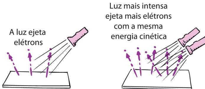
Quanto mais intensa for a luz, mais elétrons ela consegue arrancar da superfície do metal. Isto não está relacionado ao tempo de retardo da ejeção do elétron, pois ele é ejetado imediatamente, independente da intensidade da luz. Está relacionado à quantidade de elétrons ejetados. Outro detalhe é que a velocidade da ejeção dos elétrons é a mesma, não importando a intensidade da luz.
