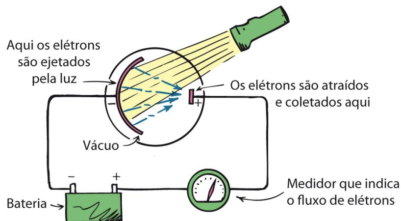
A luz que incide sobre uma superfície metálica, fotossensível e negativamente eletrizada, libera elétrons. Estes elétrons são atraídos pela placa positiva e produzem uma corrente elétrica mensurável. Se, ao invés disso, eletrizarmos essa segunda placa com uma carga negativa de valor suficiente para que ela consiga repelir os elétrons ejetados, a corrente pode ser interrompida. Podemos, então, calcular as energias dos elétrons ejetados, a partir da diferença de potencial entre as placas.
