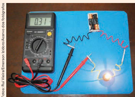
Como inserir o amperímetro no circuito.
