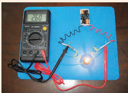
Como inserir o voltímetro no circuito.
