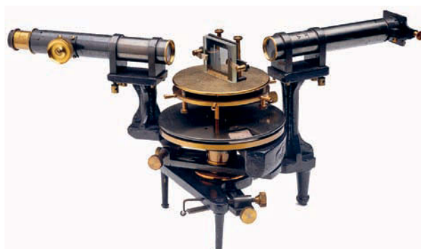
Espectroscópio com rede de difração (ainda hoje se utilizam modelos semelhantes para atividades didáticas).
