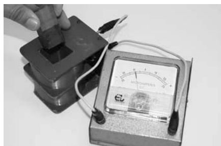
Reprodução da experiência de Faraday: o movimento do ímã provoca a oscilação do ponteiro.
