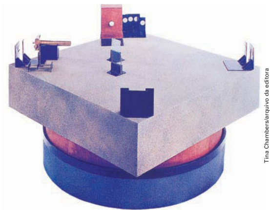
Reprodução fiel (baseada em foto) do equipamento usado por Michelson e Morley
