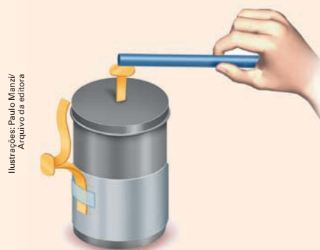
Forma de carregar eletricamente a garrafa.
