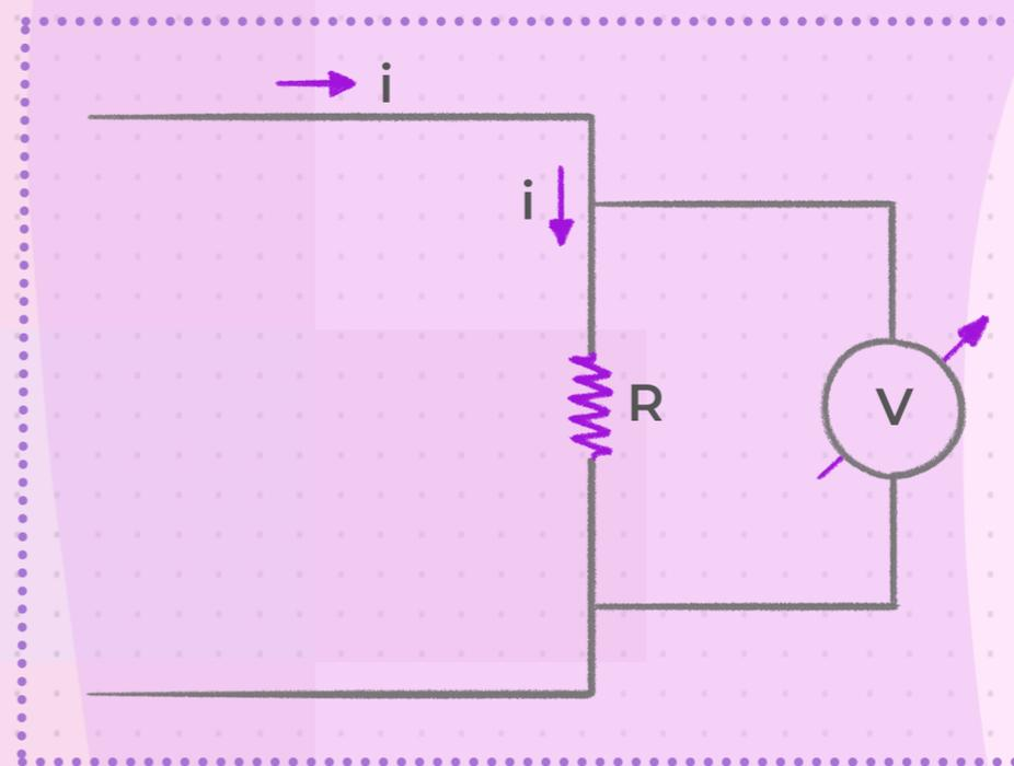
▶ Mede tensão elétrica entre dois pontos de um circuito elétrico
