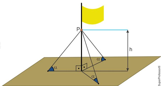
Os cabos de aço formam um ângulo  $\alpha$  com o plano do chão e instalação:
