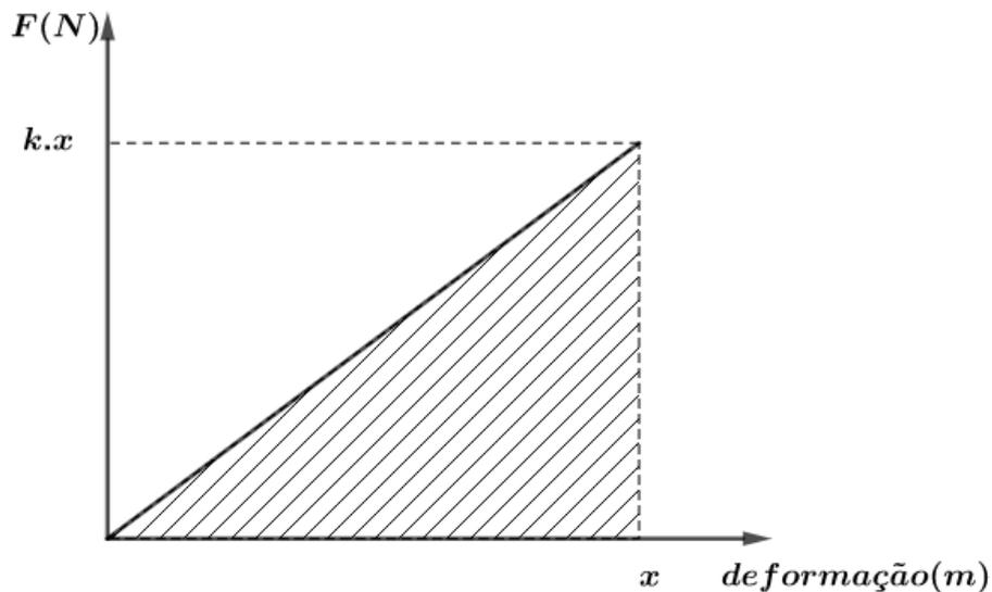
Figura 7: Gráfico da força em função da deformação.
