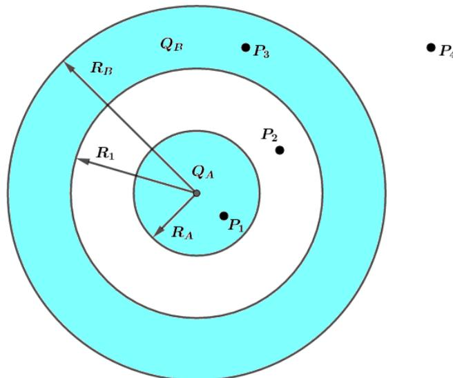
Figura 39: Cálculo do potencial em função da distância de uma carga dentro de uma casca esférica.
