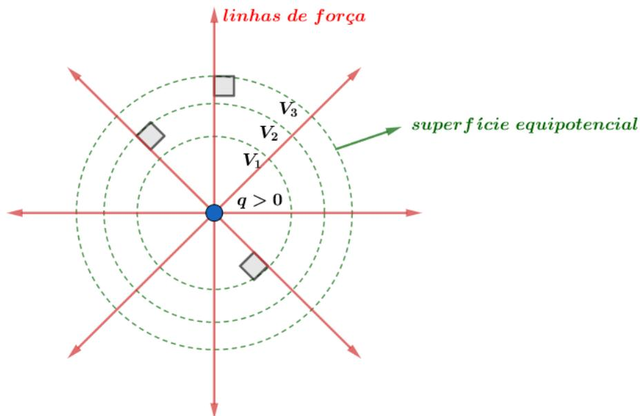
Figura 24: Superfícies equipotenciais geradas por uma carga pontual positiva.
