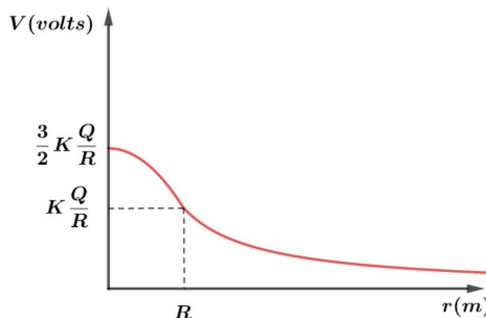
Figura 45: Gráfico do potencial elétrico em função da distância  $r$ .
