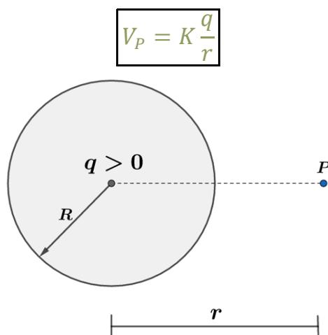
Figura 30: Potencial elétrico de um condutor esférico em função da distância ao centro dela.
