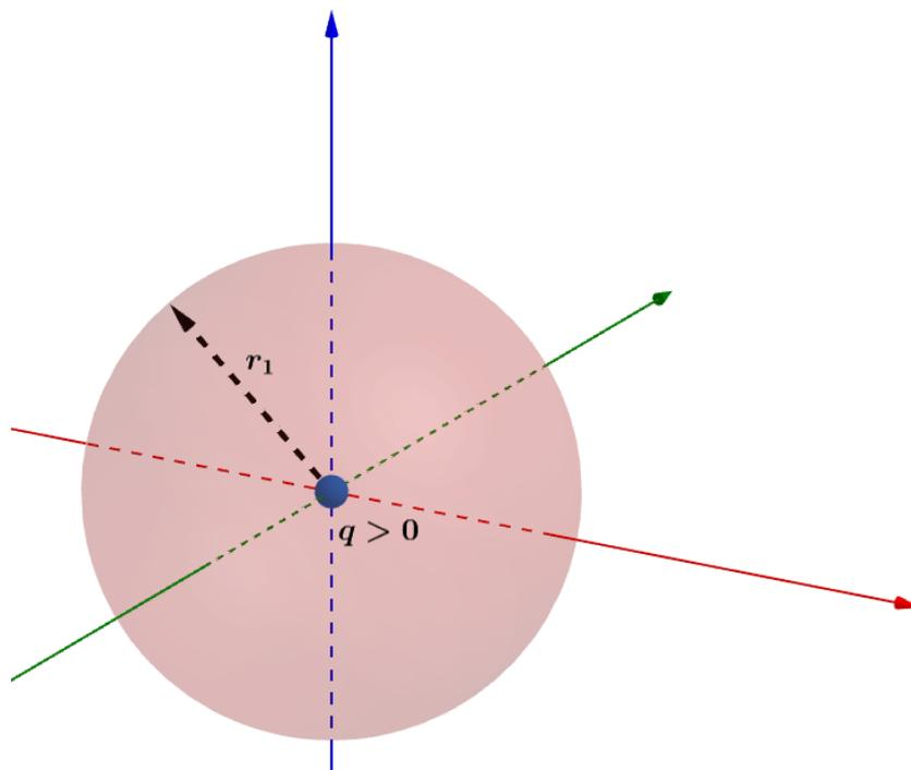
Figura 20: Superfície esférica equipotencial a uma distância  $r_1$ .
