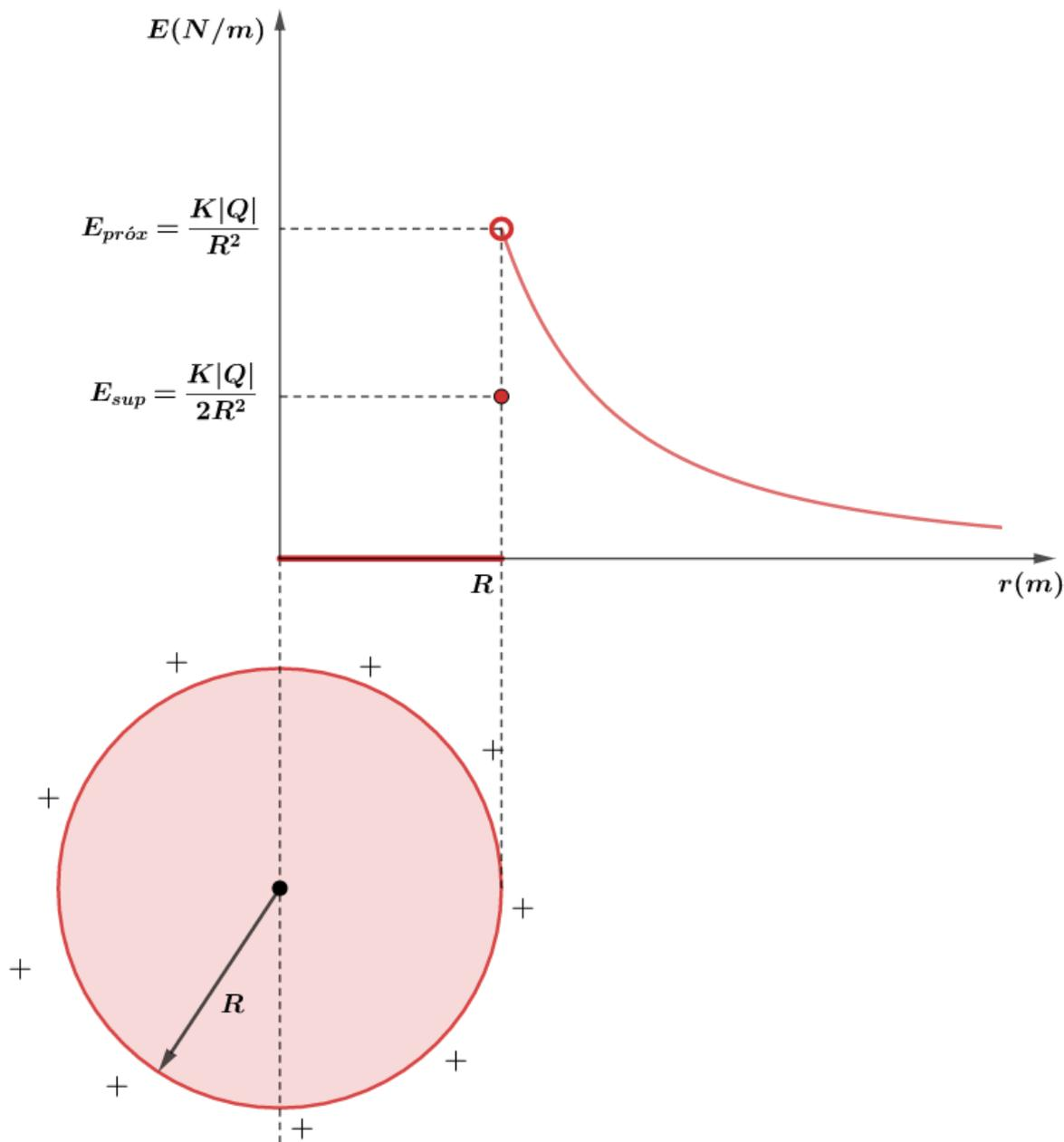
Figura 33: Campo elétrico em função da distância de um condutor carregado e em equilíbrio eletrostático.
