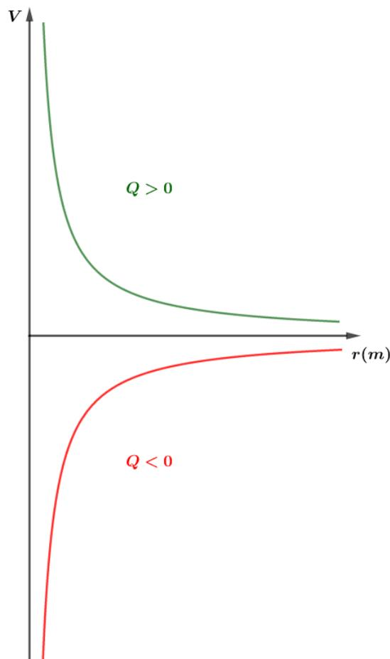
Figura 16: Gráfico do potencial elétrico gerado por uma carga puntiforme em função da distância, para os dois possíveis valores de  $Q$ .
