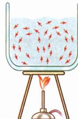
Fig. 12-7: Em um líquido, o calor se transfere de um ponto a outro devido à formação de correntes de convecção. Ilustração esquemática.
