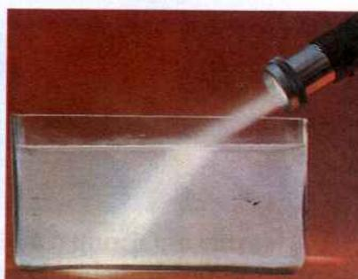
Um feixe luminoso, emitido por uma lanterna no ar, refrata-se ao penetrar na água.
