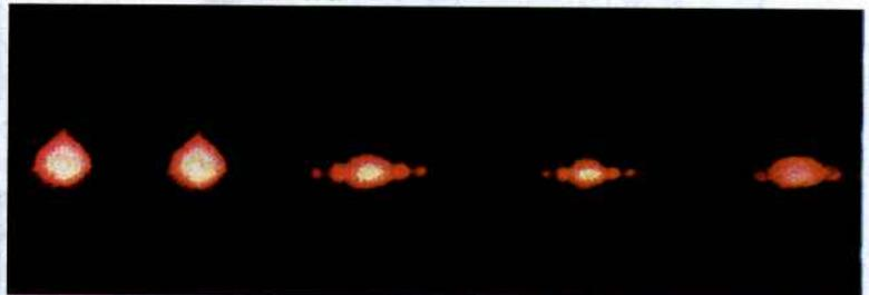
Fig. 16-25: A luz se difrata quando passa através de orifícios muito pequenos. Em uma fotografia, as dimensões do orifício parecem ser maiores do que as dimensões reais.
