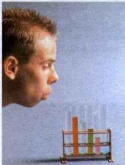
A frequência do som emitido por uma coluna de ar em vibração depende do comprimento da coluna.
