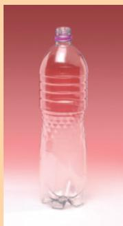
Figura b. Garrafa de plástico deformada com pressão externa maior que a interna.
