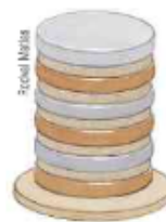
Modelo de pilha elétrica de volta.
