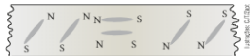
Representação simbólica de uma fita gravada : as partículas imantadas estão adequadamente posicionadas (conforme os sinais gravados).
