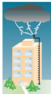
Esquema de para-raios num edifício.
