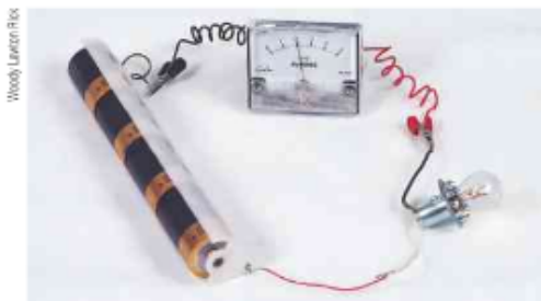
O amperímetro indica a intensidade da corrente no circuito.
