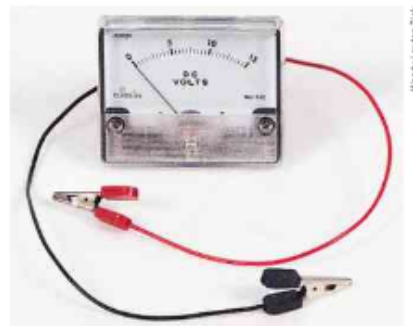
A fotografia mostra um voltmímetro, cujo valor de fundo de escala é 15 V.
