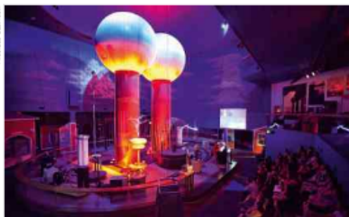
Moderno gerador eletrostático do tipo Van de Graaff, que pode produzir milhões de volts. Museu de Ciências de Boston, EUA. Junho de 2012.
