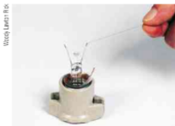
Resistor de uma lâmpada de incandescência: um fino fio de tungstênio (esticado).
