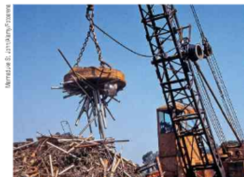
O guindaste eletromagnético retira da sucata os materiais ferromagnéticos. Carson, Califórnia.
