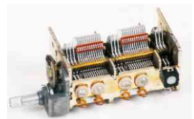
Capacitor de capacitância variável usado em circuitos elétricos.
