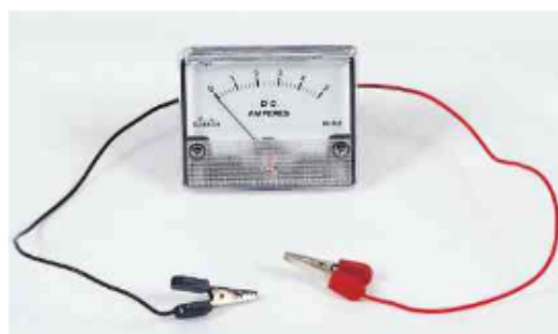
A fotografia mostra um amperímetro cujo valor de fundo de escala é 5 A.
