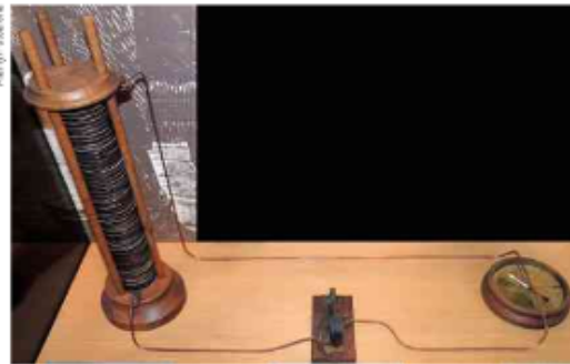
Réplica do equipamento usado por Oersted em seu experimento.
