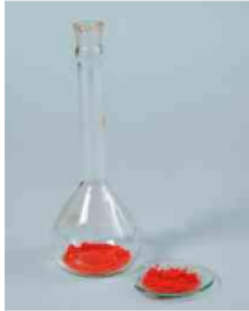
a) Coloca-se o soluto sólido no balão volumétrico.
