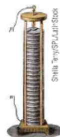
Representação de um dos primeiros modelos de pilha elétrica de zinco e prata.
