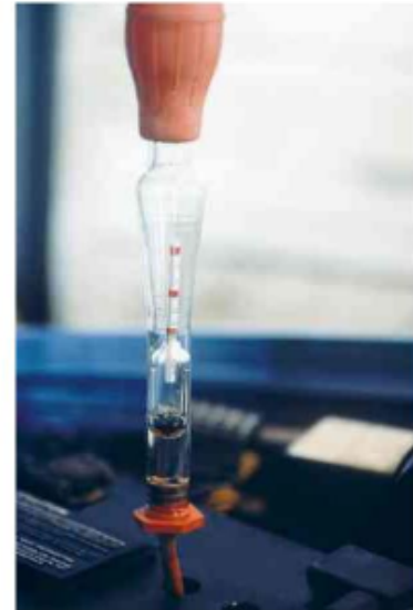
Mede-se a densidade da solução ácida introduzindo o densímetro em um vaso central e retirando uma amostra. A boia interna do densímetro indica o valor da densidade.
