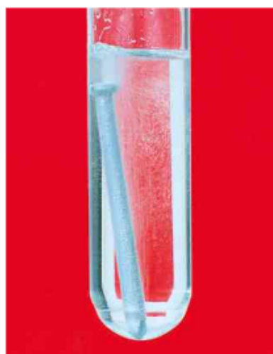
Prego de ferro imerso em uma solução de ácido clorídrico. As pequenas bolhas são constituídas de gás hidrogênio.
