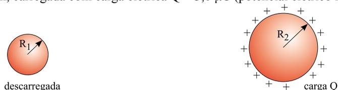
Em seguida, liga-se uma esfera à outra, por meio de um fio condutor longo, até que se estabeleça o equilíbrio eletrostático entre elas. Nesse processo, a carga elétrica total é conservada e o potencial elétrico em cada condutor esférico isolado descrito pela equação  $V = k \frac{q}{r}$ , onde  $k$  é a constante de Coulomb,  $q$  é a sua carga elétrica e  $r$  o seu raio.
