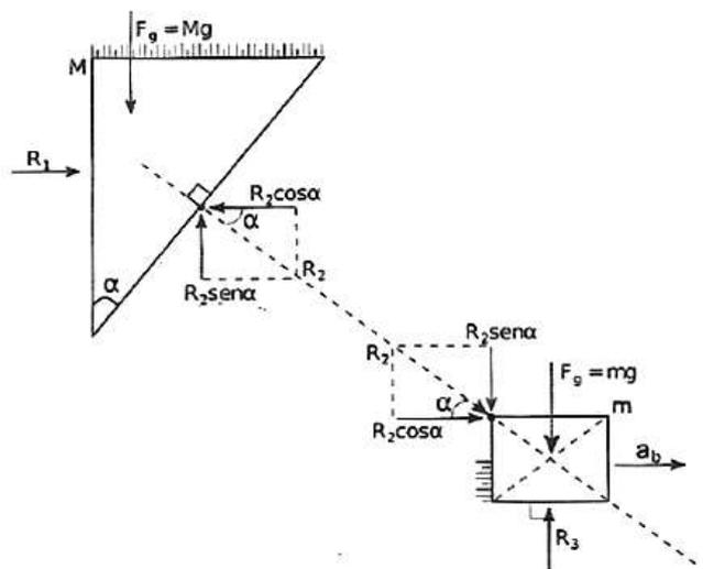
$$\text{Para cunha: } \rightarrow Mg - R_2 \cdot \text{sen}\alpha = M \cdot a_c \quad (\text{I})$$
