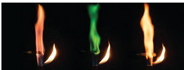
Fig. 21 Luz com cores características emitidas pelos elementos químicos: potássio, cobre e sódio, respectivamente.
