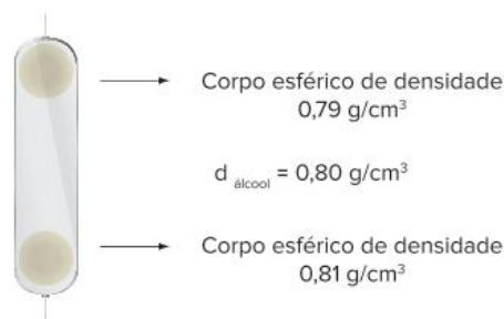
Fig. 16 Densímetro projetado para testes em amostras de álcool combustível.
