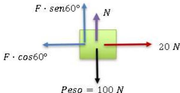
Na vertical não haverá movimentação pois o bloco está apoiado sobre o solo horizontal e a componente  $F \cdot \text{sen}60^\circ$  é menor que o peso do bloco.
