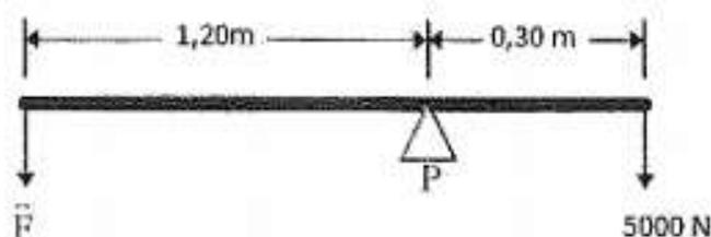
Suponha que um marinheiro levantou uma caixa de 500kg, utilizando uma alavanca. Qual é a força que ele deve aplicar na extremidade da alavanca para manter a caixa em equilíbrio?
