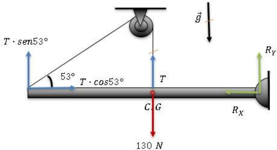
Faremos o torque resultante em relação ao ponto de apoio da barra. Considere o comprimento da barra como sendo  $2L$ .
