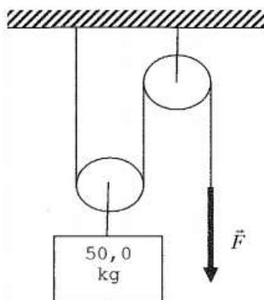
Alguns marinheiros são designados para abastecer um armazém (paiol) de explosivos com caixas de 50,0kg de explosivos cada uma. Para levantar cada caixa com maior facilidade os marinheiros montaram uma associação de roldanas representadas na figura acima.
