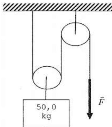
Alguns marinheiros são designados para abastecer um armazém (paiol) de explosivos com caixas de 50,0kg de explosivos cada uma. Para levantar cada caixa com maior facilidade os marinheiros montaram uma associação de roldanas representadas na figura acima.
