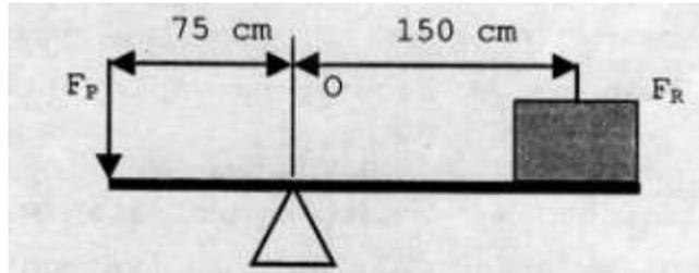
A figura acima mostra um bloco de peso  $P = 50\text{ N}$  apoiado sobre uma alavanca. Qual a intensidade da força de potência ( $F_p$ ) necessária para que a alavanca fique em equilíbrio na horizontal?
