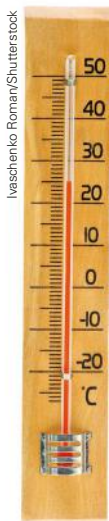
/// Termômetro de álcool. A substância termométrica (álcool) é tingida de vermelho para melhor visualização.
