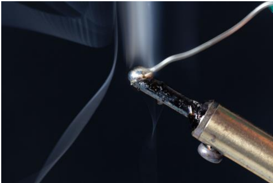
Figura 39: A Solda é uma Mistura Eutética
