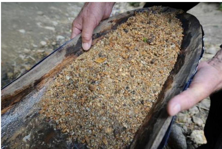
Figura 51: Levigação na Extração do Ouro nas Minas de Garimpo
