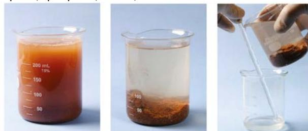
**H - Filtração:** Nesse processo, quando a mistura é despejada sobre o filtro, o sólido não dissolvido fica retido e a fase líquida passa livremente.
