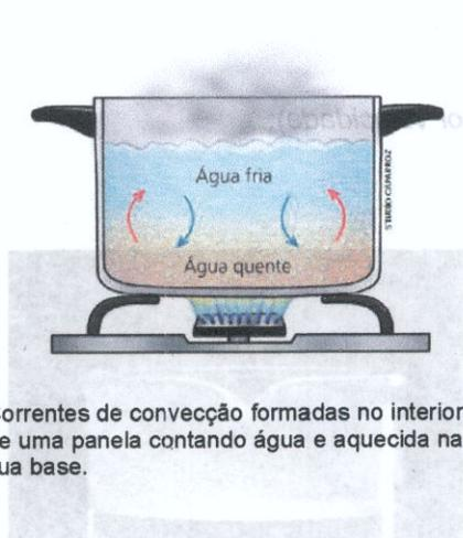
Correntes de convecção formadas no interior de uma panela contendo água e aquecida na sua base.
