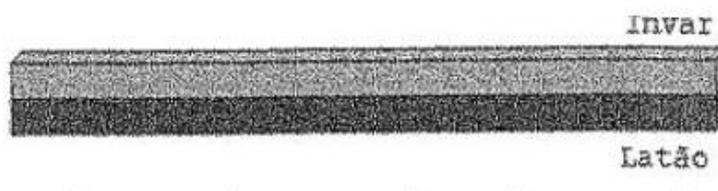
Essas lâminas são bastante usadas em disjuntores elétricos e, ao serem aquecidas, encurvam-se com a função de abrir um circuito. Esse encurvamento das lâminas é causado pelo fato de:
