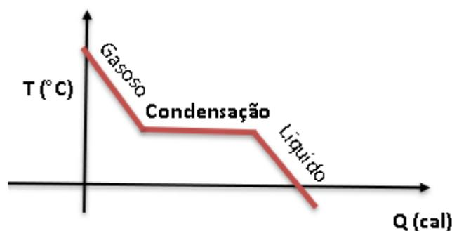
Figura 10: Curva de aquecimento para a condensação.
