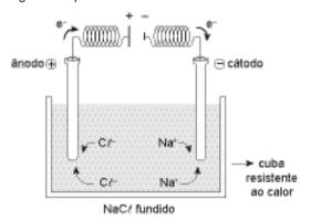
O íon sódio (Na $^+$ ) vai para o cátodo, onde se transforma em metal sódio (Na $^0$ ). O íon cloreto (C $\ell^-$ ) vai para o ânodo, onde se transforma em gás cloro (C $\ell_2$ ).
