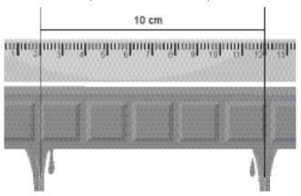
Na onda estacionária formada dentro do micro-ondas, os dois pontos derretidos indicam dois máximos de potência e a distância de meio comprimento de onda.
