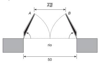
Se a ponte estiver em seu funcionamento perfeito, os pontos *A* e *B* têm alturas iguais, não importando a posição da ponte.
