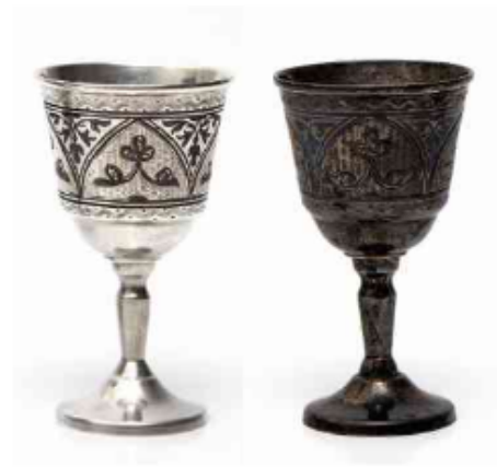
Objetos de prata: não escurecido (à esquerda) e depois de escurecer (à direita).
