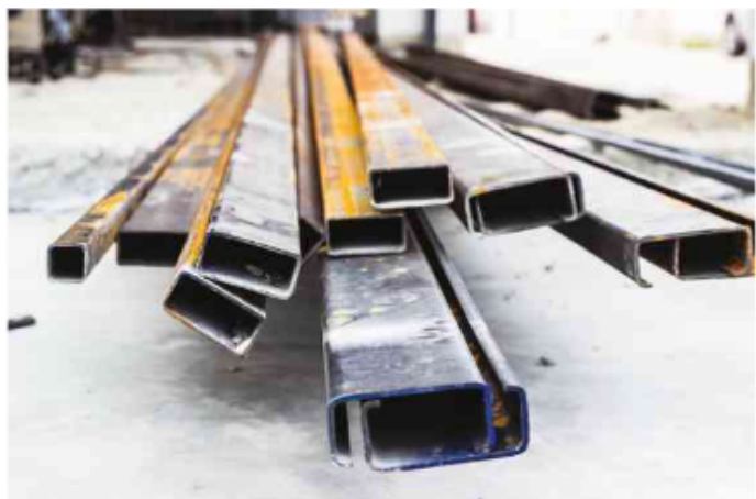
Chapas de ferro com áreas de oxidação.
