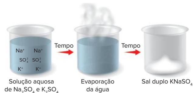
Fig. 6 Formação de sal duplo por evaporação do solvente.
