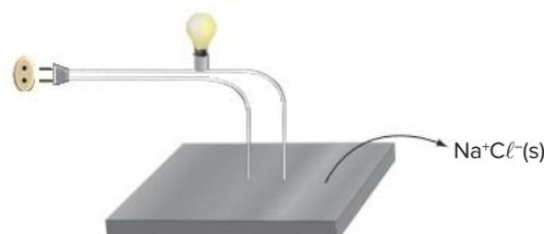
Fig. 4 Montagem experimental mostrando que os íons presos do  $\text{Na}^+\text{Cl}^-(s)$  não conduzem corrente.
