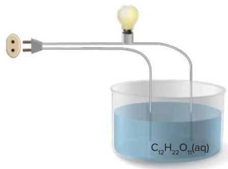
Fig. 8 Montagem experimental mostrando que o açúcar comum não conduz corrente.
