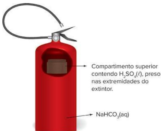
Fig. 5 Configuração simplificada de um extintor de incêndio.
