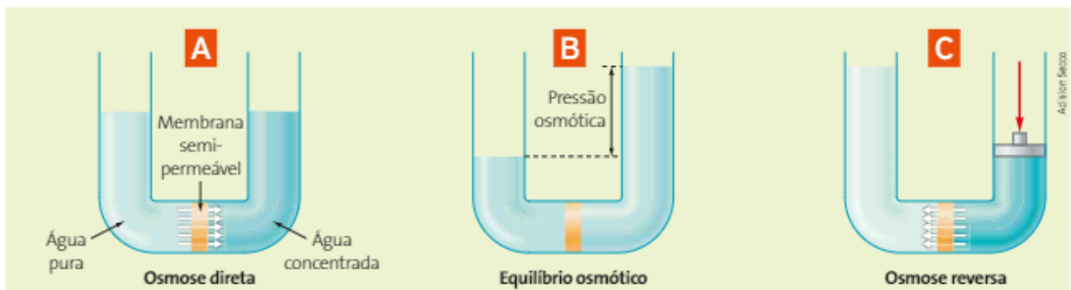
Figura 9.45. Representações esquemáticas do processo de osmose direta (A e B), levando ao equilíbrio osmótico (B), e do processo de osmose reversa (C), em que uma força (seta vermelha) é aplicada a um disco colocado na superfície do fluido de maior concentração, fazendo com que o aumento da pressão promova a passagem de água no sentido inverso, ou seja, da solução mais concentrada para a menos concentrada.
