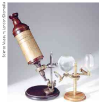
Figura 9.3. Fotografia do microscópio de Robert Hooke. O aparelho foi feito à mão, com couro e aplicações em ouro.
