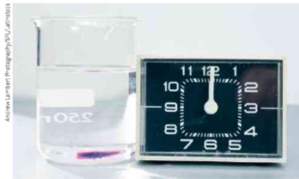
Figura 9.28. Início da experimentação: corante colocado no fundo de um recipiente com água. Montagem deixada em repouso, sem agitação.
