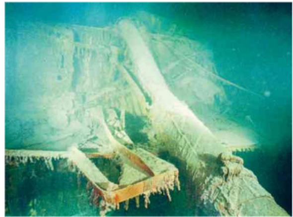
Figura 11.24. Fotografia de parte de um navio naufragado. A crosta esbranquiçada que cobre as superfícies ferrosas é formada por bactérias que obtêm sua energia a partir da oxidação do ferro.
