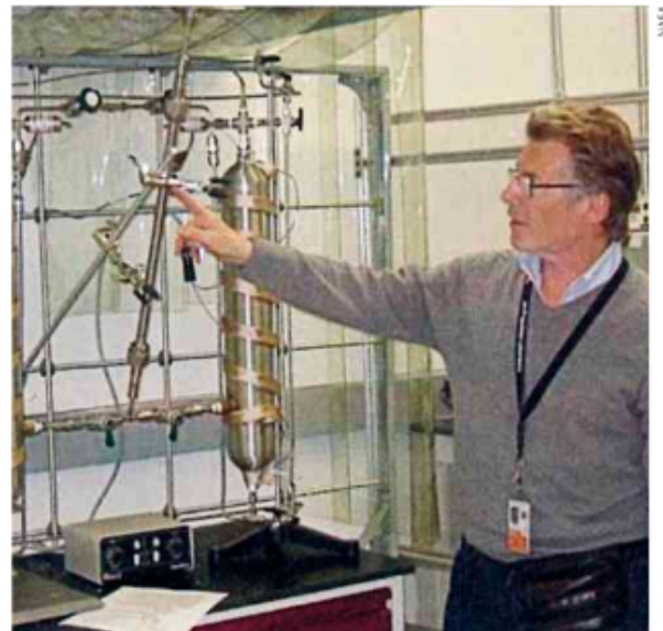
Figura 7.10. Fotografia do pesquisador Michael Russell mostrando o aparelho que simula os processos químicos que ocorrem no interior de uma fonte termal, montado por ele e seus colaboradores no Laboratório de Jato Propulsão (JPL, na sigla em inglês), na Califórnia (EUA).
