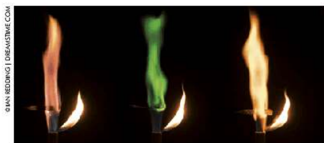
Fig. 21 Luz com cores características emitidas pelos elementos químicos: potássio, cobre e sódio, respectivamente.
