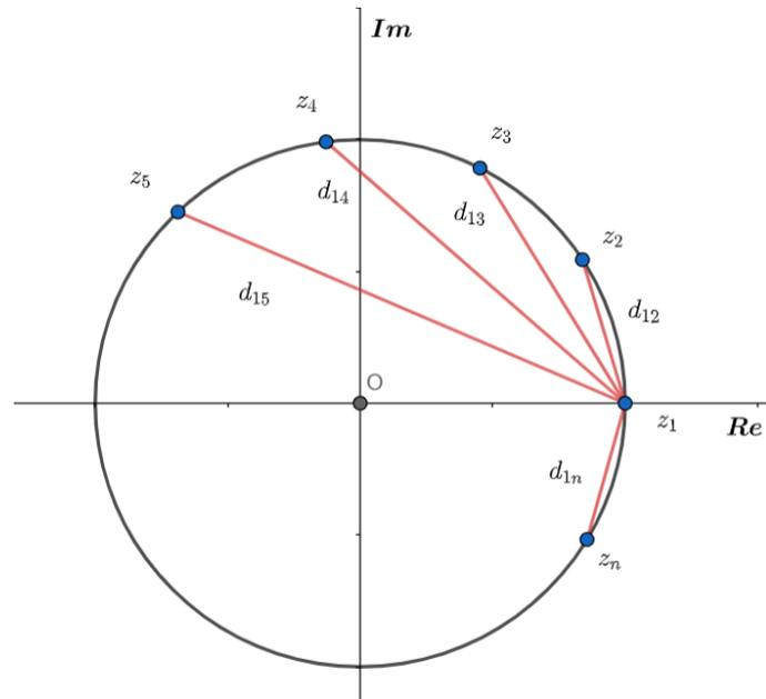
Analisando a figura, vemos que as distâncias de  $z_1$  até as raízes complexas situadas na parte positiva do eixo imaginário se repetem com as raízes complexas da parte negativa do eixo imaginário. Pois:
