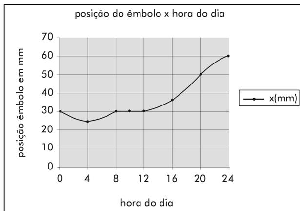
O gráfico acima representa os resultados de um experimento que consistiu em variar, sob pressão atmosférica constante, a temperatura do gás ao longo de um dia, registrando-se a posição do êmbolo.
