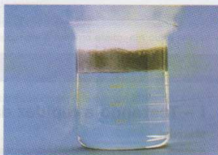
H_2O_2 com MnO_2 em decomposição acelerada.
