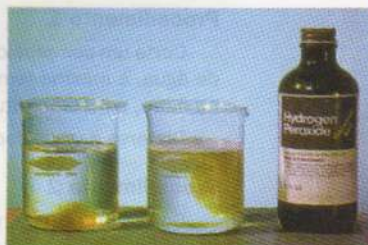
Uma gota de sangue foi adicionada à água (à esquerda) e à água oxigenada (à direita). Note a efervescência neste último frasco.
