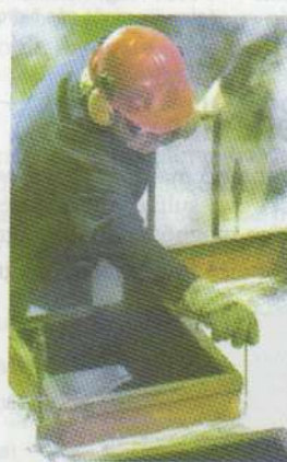
O alumínio fundido é colocado em moldes, nos quais se solidifica.
