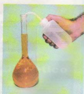
Adiciona-se água para completar o volume.
