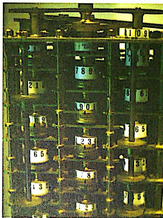
Detalhe da "máquina diferencial", idealizada por Babbage.
