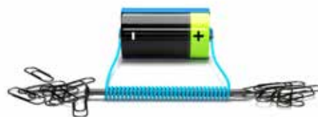
Um solenoide por onde passa uma corrente elétrica (proveniente da pilha) gerando um campo magnético capaz de atrair metais.
