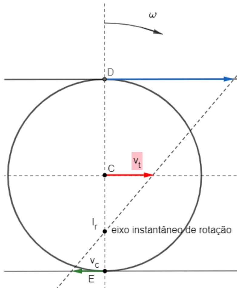
Figura 24: Determinação geométrica do eixo instantâneo de rotação.
