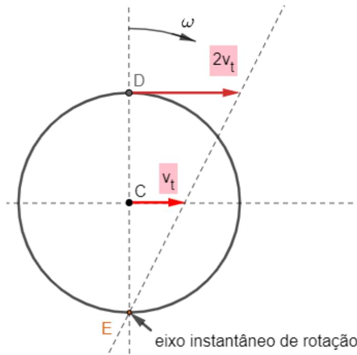
Figura 22: Determinação geométrica do eixo instantâneo de rotação.
