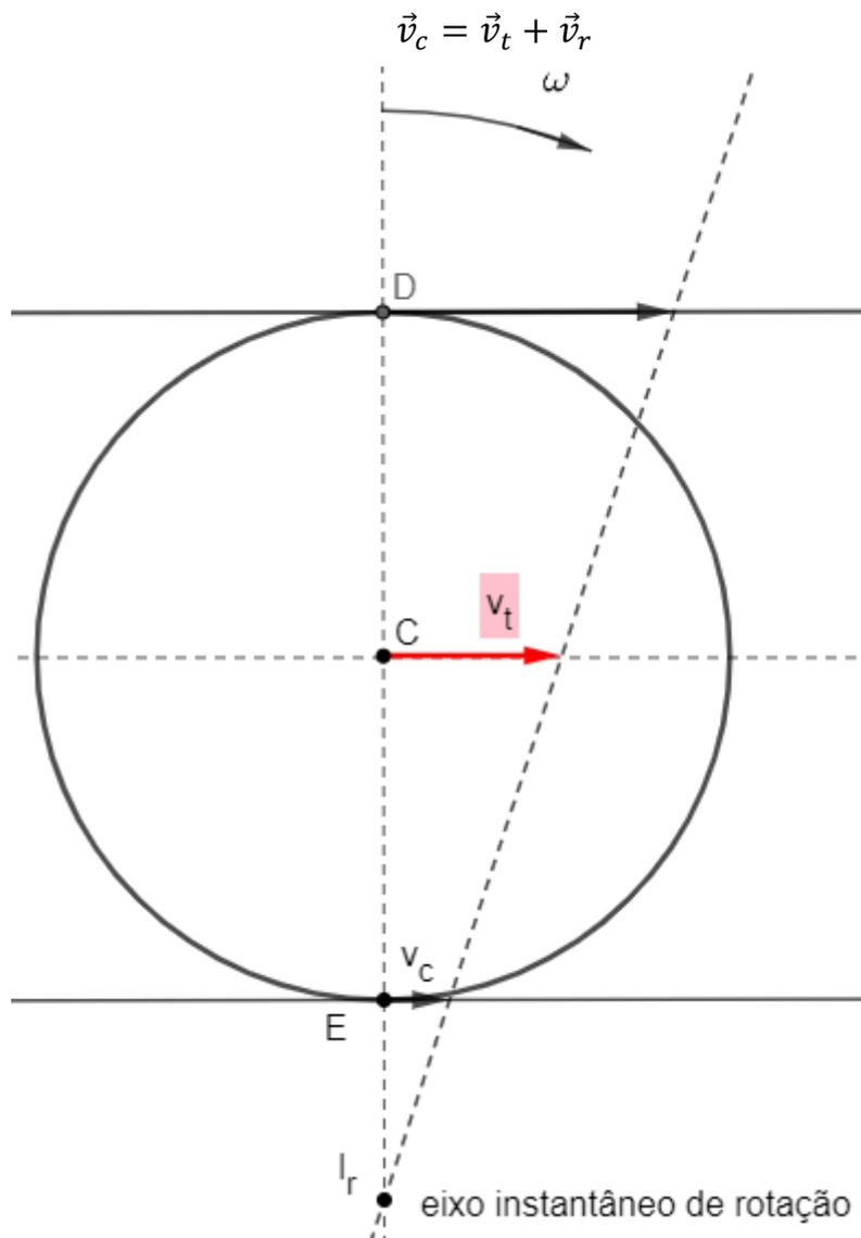
Figura 23: Determinação geométrica do eixo instantâneo de rotação.
