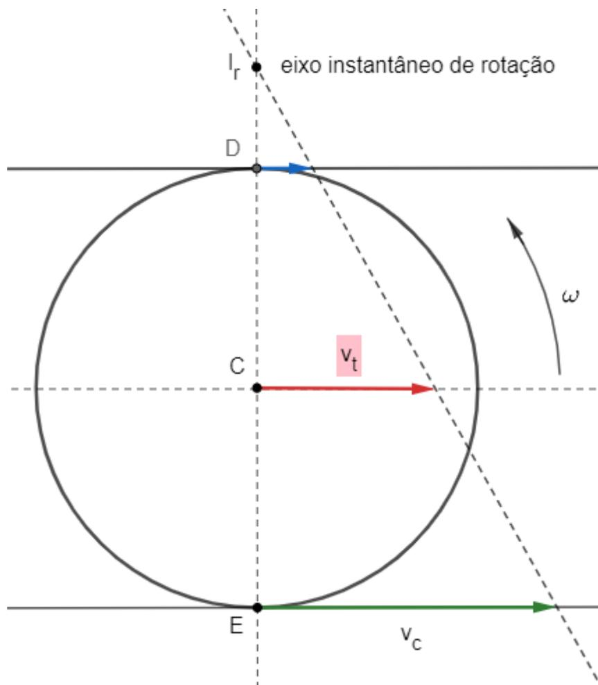
Figura 26: Determinação geométrica do eixo instantâneo de rotação.
