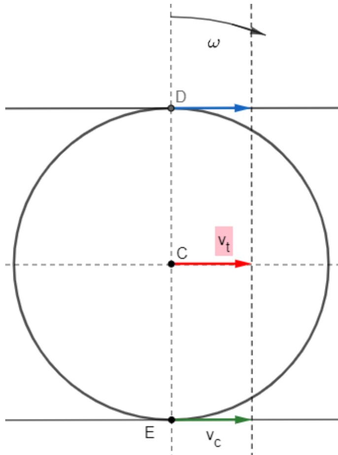
Figura 25: Determinação geométrica do eixo instantâneo de rotação.
