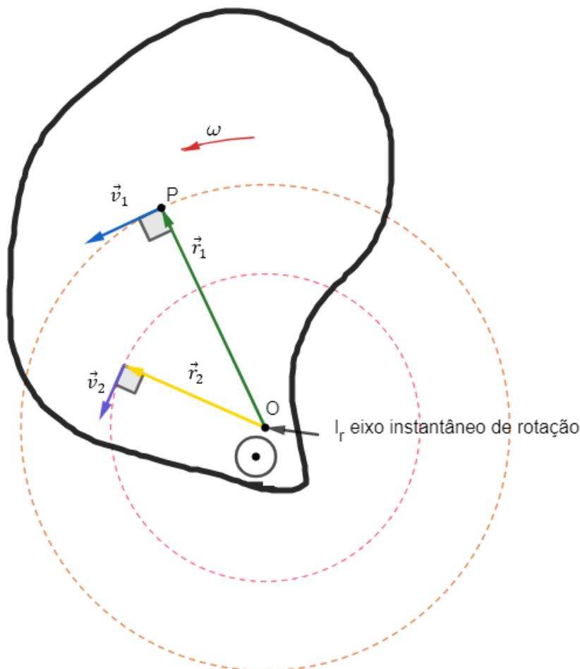
Figura 19: Determinação geométrica do eixo instantâneo de rotação.
