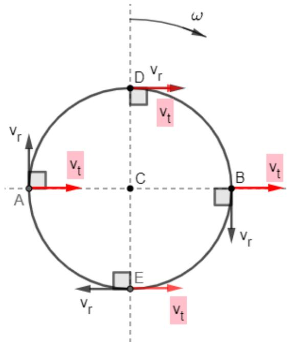
Figura 21: Velocidade de translação e rotação para a roda sem deslizamento.
