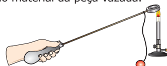
Figura 7. Montagem para comprovar a dilatação térmica de um anel metálico.
