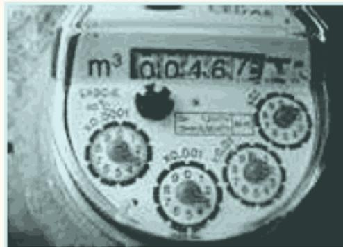
O consumo de água das residências que possuem água encanada é medido por um aparelho chamado hidrômetro. O hidrômetro utiliza, como unidade de medida, o metro cúbico.
