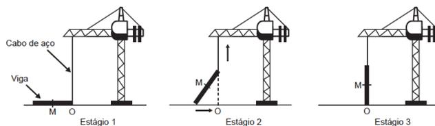
Na figura, o ponto  $O$  representa a projeção ortogonal do cabo de aço sobre o plano do chão e este se mantém na vertical durante todo o movimento de içamento da viga, que se inicia no tempo  $t = 0$  (estágio 1) e finaliza no tempo  $t_f$  (estágio 3). Uma das extremidades da viga é içada verticalmente a partir do ponto  $O$ , enquanto que a outra extremidade desliza sobre o solo em direção ao ponto  $O$ . Considere que o cabo de aço médio do segmento que representa a viga.
