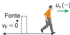
$$f' = f \cdot \left( \frac{v_{\text{som}} - u_x}{v_{\text{som}}} \right) \Rightarrow f' = 2.000 \cdot \left( \frac{330 - 3,30}{330} \right) \Rightarrow$$
