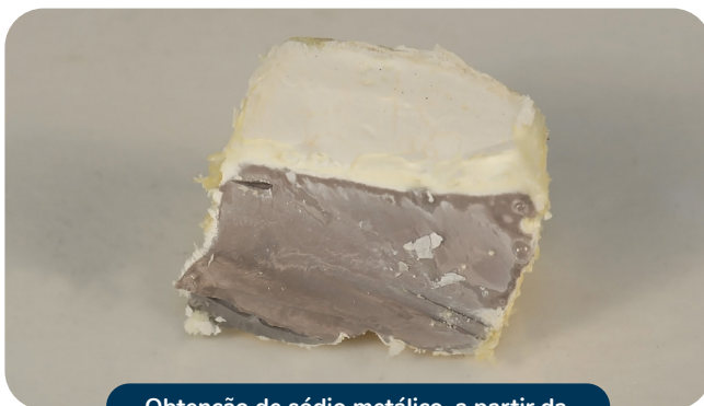
Obtenção de sódio metálico, a partir da eletrólise ígnea do cloreto de sódio líquido.
