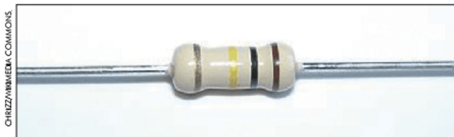
Fig. 2 Resistor utilizado em circuitos eletrônicos.
