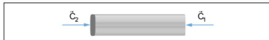
Fig. 23 Barra sujeita a compressão.
