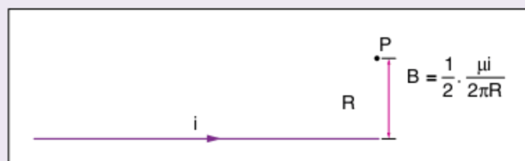
Fig. 7 Campo magnético gerado na extremidade de fio retilíneo semi-infinito.
