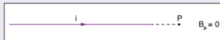
Fig. 8 Campo magnético gerado no prolongamento de fio retilíneo.
