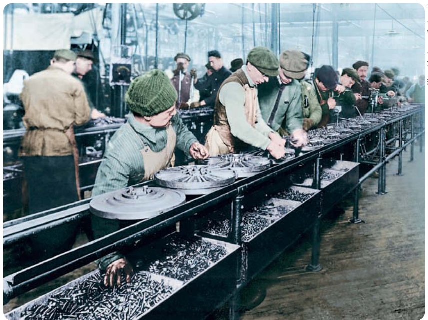
▲ Linha de montagem (volante para o automóvel Ford, Modelo T) em foto de 1911. O Modelo T foi produzido entre 1908 e 1927 e se tornou um símbolo da produção em série na indústria automobilística.
