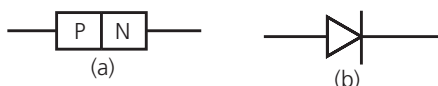
Esquema de um diodo de junção pn (a) e sua representação em circuitos (b)
