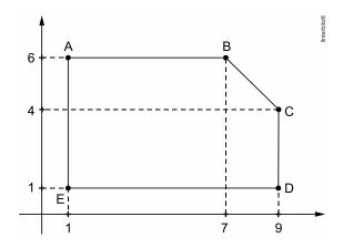
Dada a escala de 1:500 e sendo as coordenadas em centímetros, podemos concluir que cada centímetro na figura corresponde a 5 metros. Assim, queremos calcular o valor de
