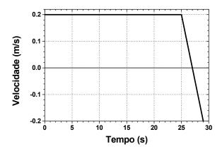
O gráfico acima, em função do tempo, descreve a velocidade de um carro sendo rebocado por um guincho na subida de uma rampa. Após 25 s de operação, o cabo de aço do guincho rompe-se e o carro desce rampa abaixo.
