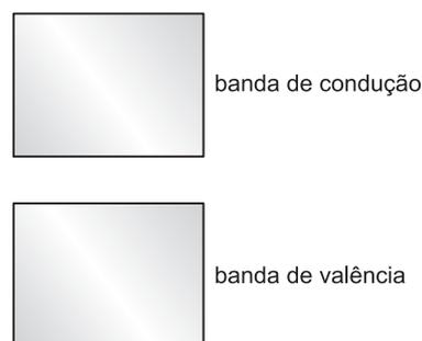
Quando o semicondutor é aquecido, elétrons podem ser excitados da banda de valência para a de condução. Assim, a resistência de um semicondutor diminui com o aumento da temperatura.
