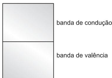
Os elétrons que estão na **banda de condução** podem mover-se livremente pelo sólido produzindo uma corrente elétrica.
