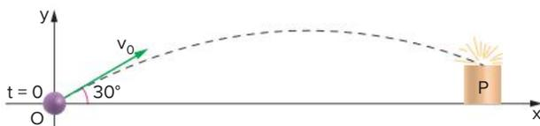
Desprezando as influências do ar e considerando  $g = 10 \text{ m/s}^2$ , determine o instante em que o projétil atinge o prédio P, de 45 m de altura.
