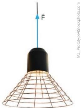
Fig. 5 Força de contato  $\vec{F}$  exercida por uma luminária em um fio.
