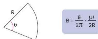
Fig. 11 Campo magnético gerado por trecho circular percorrido por corrente.
