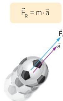
Fig. 12 Vetores aceleração e força resultante atuando sobre uma bola.
