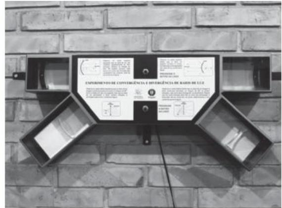
Nos compartimentos inferiores do dispositivo, há dois tipos de lentes, sendo possível observar a convergência e a divergência dos raios de luz que incidem nas lentes e delas emergem ao se acionar um botão. Com base na imagem e nos conhecimentos sobre lentes esféricas, assinale a alternativa que apresenta, corretamente, o caminho percorrido pelos raios de luz.
