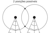
Usando no mínimo três antenas, obtém-se a posição exata do celular por meio do tempo de resposta de cada uma das torres.
