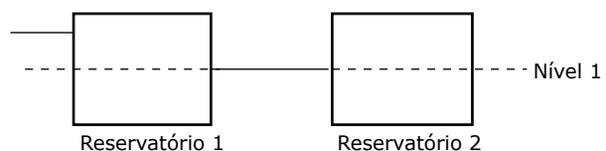
Com a vazão constante, a altura  $h$  do nível-d'água subirá no reservatório 1 de forma linear até atingir o nível 1 (no tempo  $t_1$ ). Nesse instante, toda a água que entra no sistema alimentará o reservatório 2, pelo cano de ligação, até que este atinja o nível 1 (no tempo  $t_2$ ).
