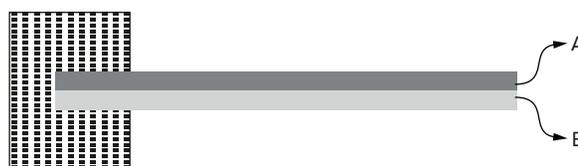
Considere que ambas as lâminas estão inicialmente sujeitas à mesma temperatura  $T_0$ , e que a relação entre os coeficientes de dilatação linear seja  $\alpha_A > \alpha_B$ . Ao aumentar a temperatura da lâmina bimetálica, é correto afirmar que
